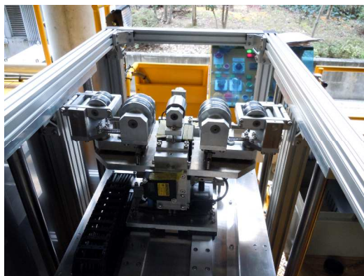
架線測定装置
