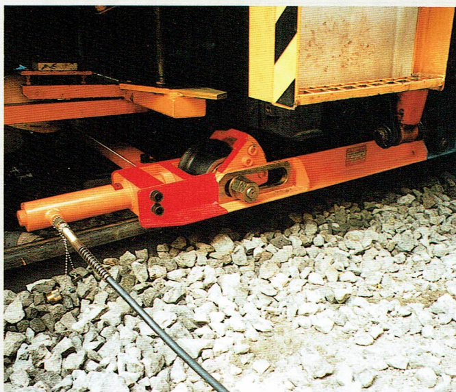
■ KU-水平シリンダー及びロック機構
